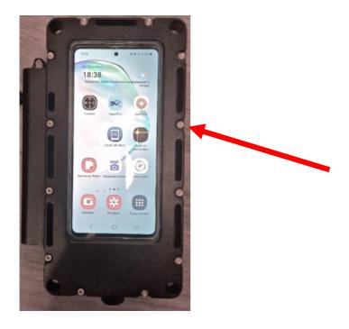
Зафиксировать планшет, стилусом активировать символ « — ». Приложение «AquaTab Clinometer» переходит в режим измерения угла, фиксируя на экране нулевое положение. При перемещении планшета к другой поверхности, на экране появляется синий сектор, указывающий на образование угла между поверхностями.
